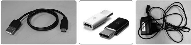
그림 1-3 USB Type-C 케이블, 마이크로 USB 변환 젠더, 마이크로 USB DC 어댑터
