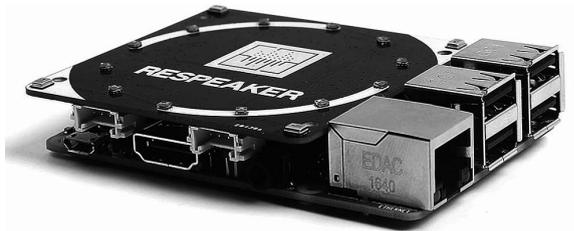
그림 13-1 리스피커(Respeaker) 4Mic 실드 보드가 장착된 모습
