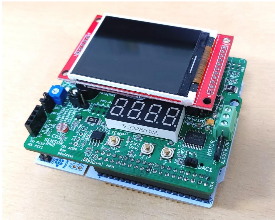
<JKIT-Nucleo-64에 2.2인치 TFT-LCD를 더 장착한 모습>
