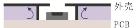
图12. 传感器与外壳内部空气进行隔离，将外壳内部密闭空气对传感器的影响降到最低。
