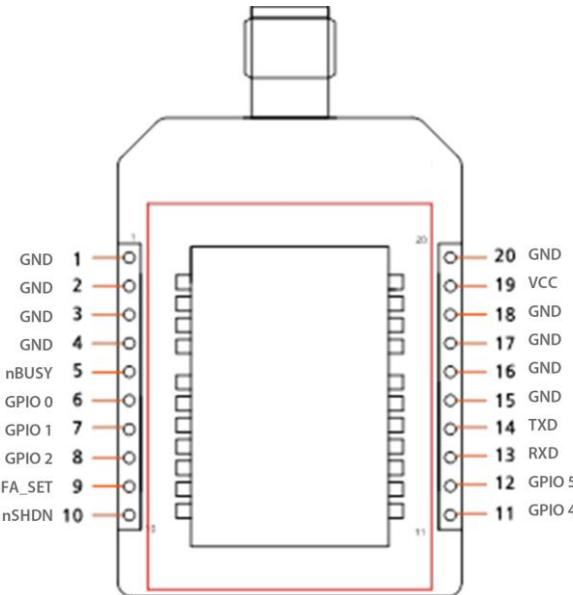
그림 : AirBon-F400SN 핀 구성
