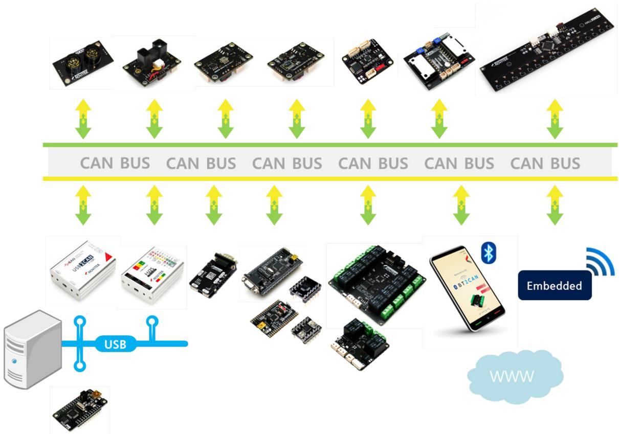
RELAY2CAN 2CH뿐만 아니라 차후 출시될 다중/다수의 센서 및 기타 제어기들과 하나의 CAN 네트워크로 구성될 수 있다. 이는 시스템 개발에 필요한 시간을 획기적으로 단축시켜 줄 수 있으며, 전장이나 배선이 비교적 간편해 질 수 있음을 의미한다.
