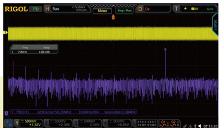
Near Field(니어 필드) 프로브를 사용하여 프로브가 방사선 누출 지점에 접근할 때 주파수 영역의 스펙트럼 피크를 쉽게 관찰할 수 있습니다.
