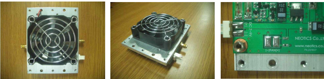
(동일 구조의 증폭기의 뒷면 방열판에 별매의 PN-FAN-G6005 팬(FAN) 장착모양)
