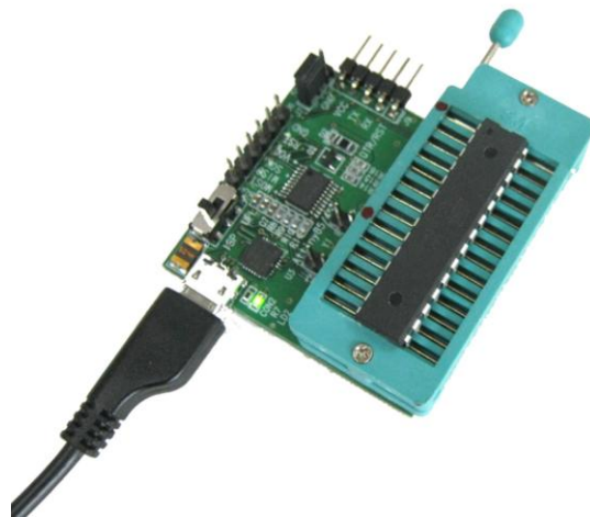
(JARDUINO-LOADER-2에 ATmega328 칩을 장착하여 부트로더 굽기를 실행하는 모습)
